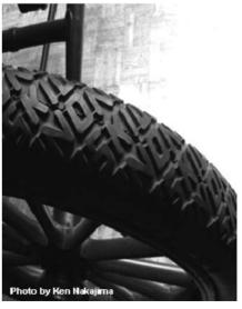
図2 NONSKID文字が彫られたタイヤトレッドパターン
