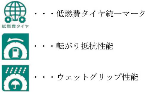
また、転がり抵抗とウェットグリップのグレードは、以下のようタイヤ性能評価値によって等級区分がされています<sup>1)</sup>。転がり抵抗係数RRC=10.0のタイヤを四本装着した重さ1トンの自動車は、100N(約10kgf)の力が転がり抵抗として発生します。ウェットグリップ性能を示すGは、基準タイヤの基準試験条件における最大制動力係数または減速度に対するインデックス値(%)で表されます。すなわち、低燃費タイヤであること条件としては、基準試験条件において転がり抵抗係数が9.0以下、かつ、ウェットグリップ性能が基準タイヤの110%以上あることが求められます。もちろん、これらの数値は決められた基準試験条件での数値になるので、比較のための目安でしかありません。実際の使用にあたっては、転がり抵抗やウェットグリップ性能は、使用条件によって変化します。
