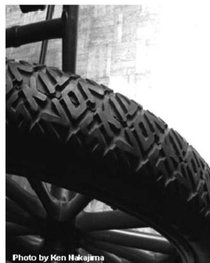
図2 NONSKID文字が彫られたタイヤトレッドパターン
