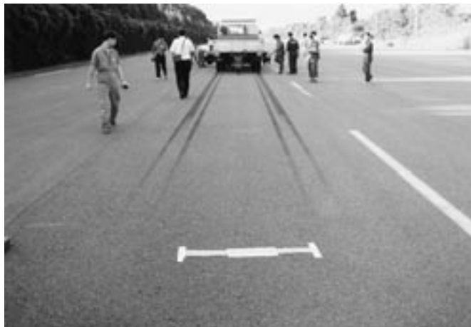
日本自動車研究所 試験コースにて ブレーキのスリップ痕 科学警察研究所の鑑定研究
